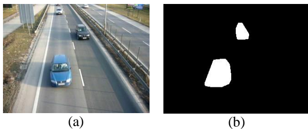
Obr. 8. Nahradenie nájdených kontúr v maske popredia ich konvexnými tvarmi. Obrázok (b) je konečná podoba binárnej masky popredia pôvodnej snímky (a).
