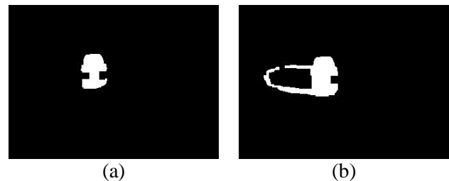
Obr. 7. Morfológické operácie na binárnej maske popredia (znázornenej na Obr. 6. (b)). Obrázok (a) vznikol aplikovaním morfológických operácií uzatvorenia a otvorenia. Na obrázku (b) je pre porovnanie znázornená maska, ktorá je výsledkom segmentácie bez odstraňovania tieňov.
