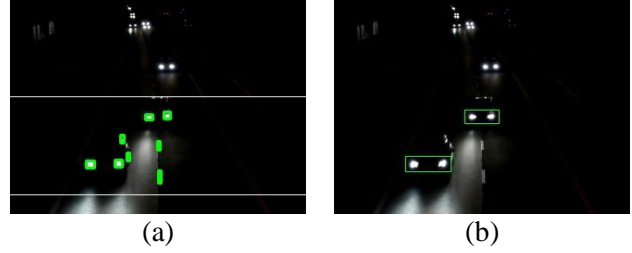
Obr. 3. Párovanie svetlometov. Z množstva nájdených kandidátov na svetlomet v snímke (a) boli algoritmom vybrané správne dvojice predných svetlometov vozidiel (b).
