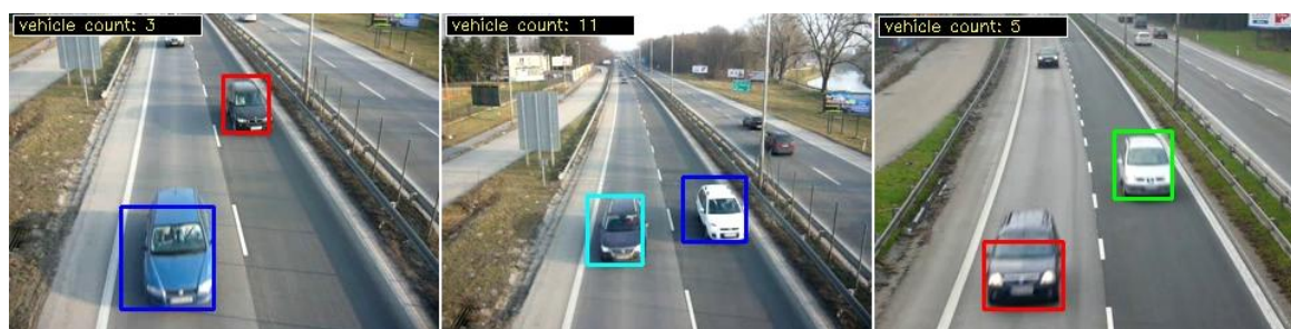
Obr. 21. Znáozornenie funkčnosti systému denného monitoringu založeného na rozdieli sekvencií snímok na troch rôznych videách
