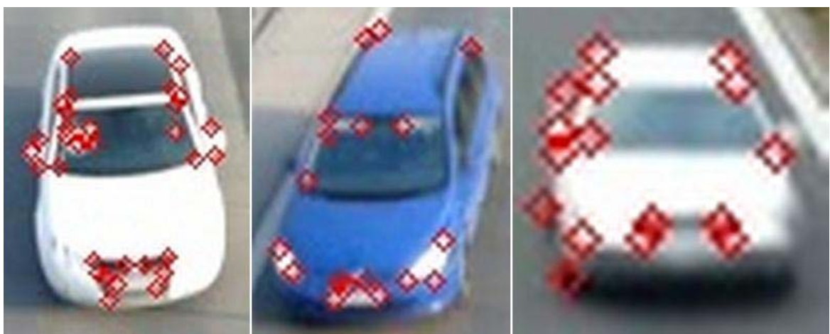
Obr. 13. Príklad nájdených silných rohov na vozidlách
