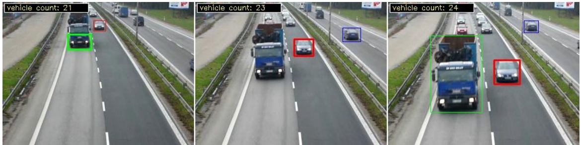
Obr. 30. Zaujímavá situácia. Dvakrát zarátaný nákladný automobil. Z dôvodu straty sledovania jeho pohybu bol dvakrát nájdený, dostatočne dlho sledovaný, a teda aj zarátaný.
