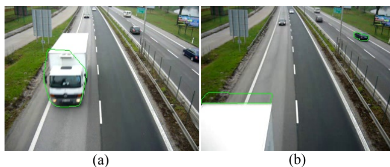
Obr. 22. Zaujímavá situácia. Po prechode správne nájdeného vozidla (a) bol nesprávne zaznamenaný pohyb jeho konca (b). Vozidlo však bolo zarátané korektne
