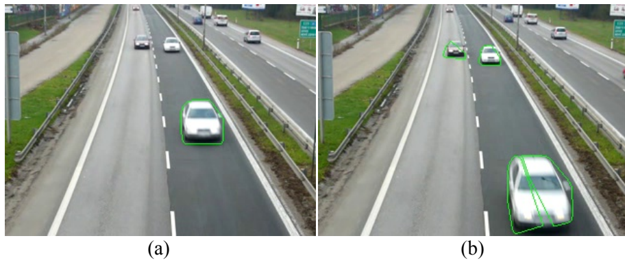
Obr. 28. Zaujímavá situácia. Nie príliš nezvyklá situácia rozdelenia kontúry vozidla v nižšej časti snímky (b) z dôvodu jeho rozmazania kvôli pomalej uzávierke kamery. Vo väčšej diaľke je vozidlo ostrejšie a kontúra určená správne (a).
