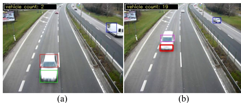
Obr. 23. Zaujímavé situácie. Z dôvodu chybnjej segmentácie bolo vozidlo na obrázku (a) určené ako dva automobily. Zarátané bolo správne. Vozidlo na obrázku (b) však z rovnakého dôvodu bolo chybnje zarátané dvakrát.
