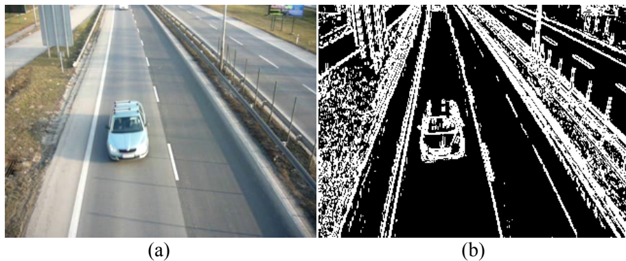
Obr. 16. Odstraňovanie tieňov pomocou detekcie hrán. V pôvodnej snímke (a) sú nájdené silné horizontálne a vertikálne hrany (b).
