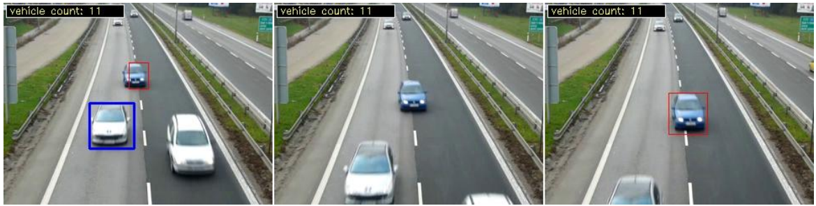
Obr. 29. Zaujímavá situácia. Nezarátané modré vozidlo z dôvodu straty sledovania jeho pohybu, a teda získania nedostatočného počtu snímkov, v ktorých muselo byť sledované, aby bolo zarátané.
